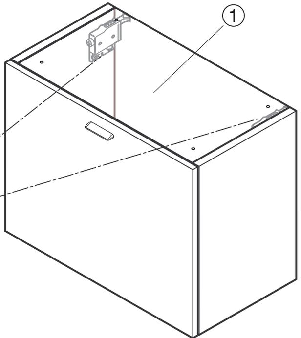
Hängerbeschlagn bei Schubkastenelementen.
