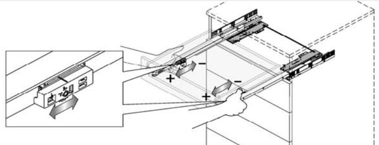
Auswurfkraft / Activation force / Force d'ouverture / Forza di sgancio / Fuerza de Activación / Öppningsimpuls / сила выталкивания
