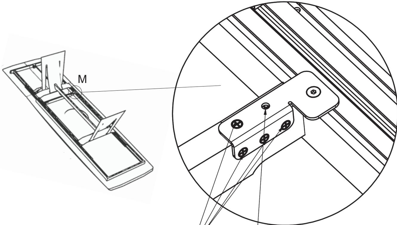
Step 1: Diese 4 Schrauben lösen
