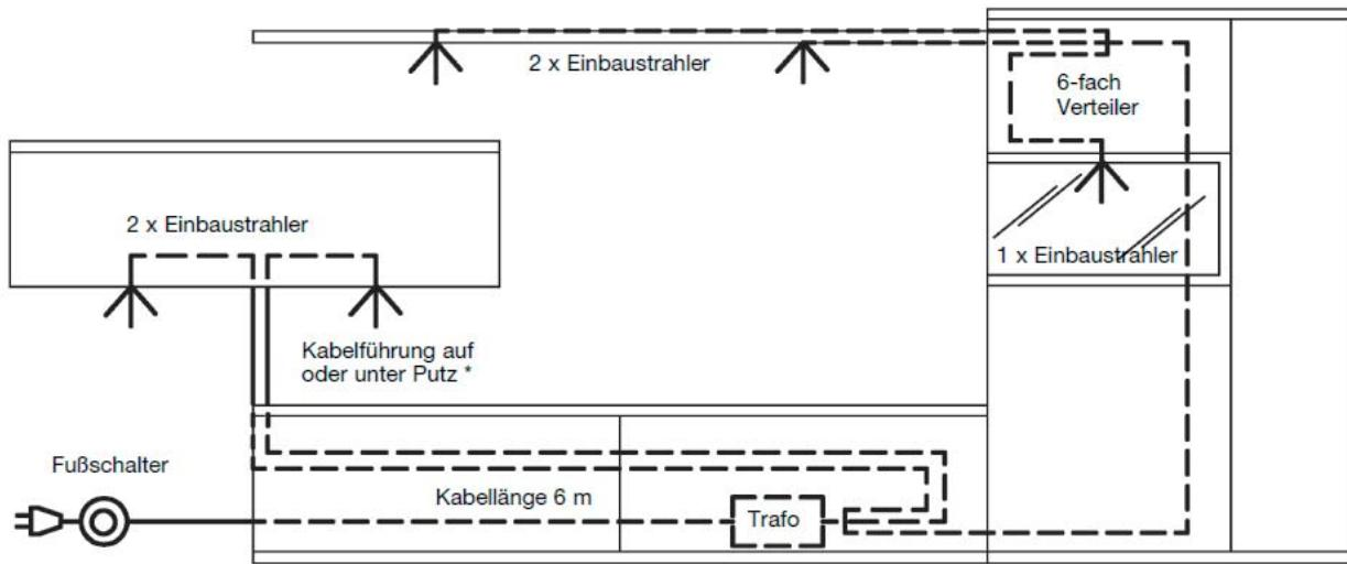
**Achtung:** Kabellänge von Trafo bis Strahler max. 4 m.
