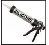
**Hinweis!** Verkleben Sie mit einem Fugendichtstoff auf Silikonbasis der transparent, lösemittelfrei und neutral vernetzend ist.
