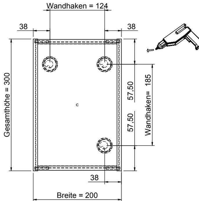
Abb. senkrechte Montage, waagerechte Montage möglich.
