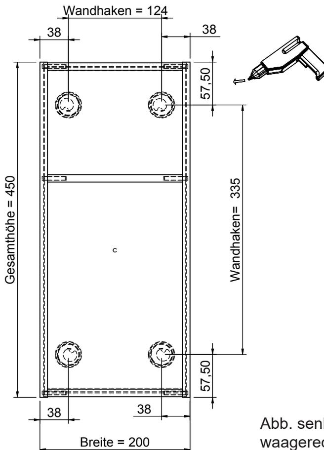
Abb. senkrechte Montage, waagerechte Montage möglich.
