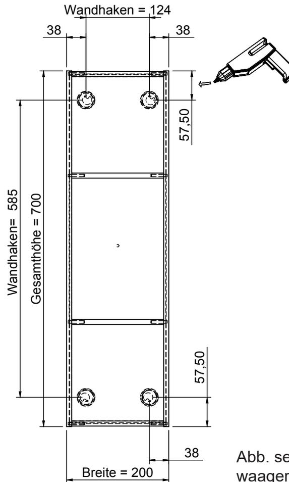
Abb. senkrechte Montage, waagerechte Montage möglich.
