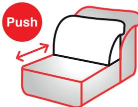
Die Position der Rückenlehne ist manuell verstellbar. Um die Rückenlehne zu verstellen, drücken Sie diese im Sitzen mit den Ellenbogen nach hinten weg. Die Rückenlehnen-Verstellung kann nur in eine Position nach hinten erfolgen. Um die Rückenlehne wieder nach vorne zu verstellen, ziehen Sie diese wieder in Richtung des Sitzes.
